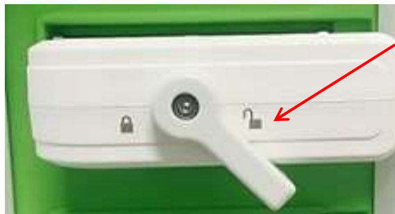
Abbildung 9: Entriegelter Verriegelungsknopf am Sondenstecker
